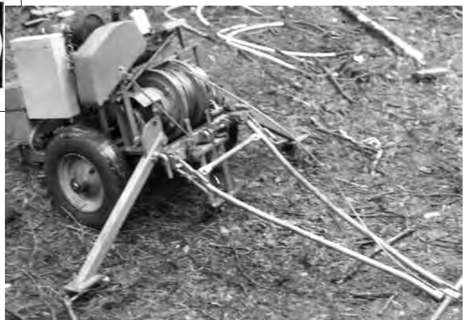
Abb. 1/15: Serien-Kleinseilwinde LRW 6-011 vom StFB Schwerin mit Funkfern-Steuerung ausgerüstet (Archiv ZiP)
